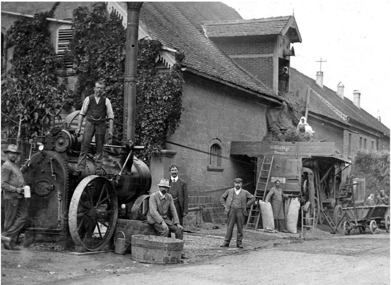
Eine Dampfdreschmaschine arbeitet um 1900 an der Scheune von Bötsch. Sitzend vor der Maschine eventuell Josef-Leonhard Bötsch, stehend daneben der Besitzer der Maschine Gottfried Meyer.
